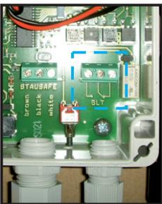
Die Elektronik verfügt über einen potentialfreien Kontakt. Dieser Anschluß kann für externe Signalgeber oder die Gebäudeleittechnik verwendet werden. Der Kontakt ist passiv, d.h. es muss eine externe Spannung angelegt werden. Bei Störung wird der potentialfreie Kontakt (230V/0,5A) (3 Sekunde aktiv, 17 Sekunden Pause) aktiviert. Dadurch kann das CLOSED Signal z.b. für eine Lampe oder eine Hupe weitergeleitet werden.
