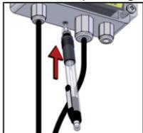
7. Multitaster (9) mit Hilfe eines Kugelschreibers oder kleinen Schraubendrehers durch den Wasserschutzstopfen (11) kurz drücken (max. 2 Sek.). Anzeige „CLOSED“ und das akustische Signal sprechen an. Die Verschlussklappe schließt und öffnet wieder.
